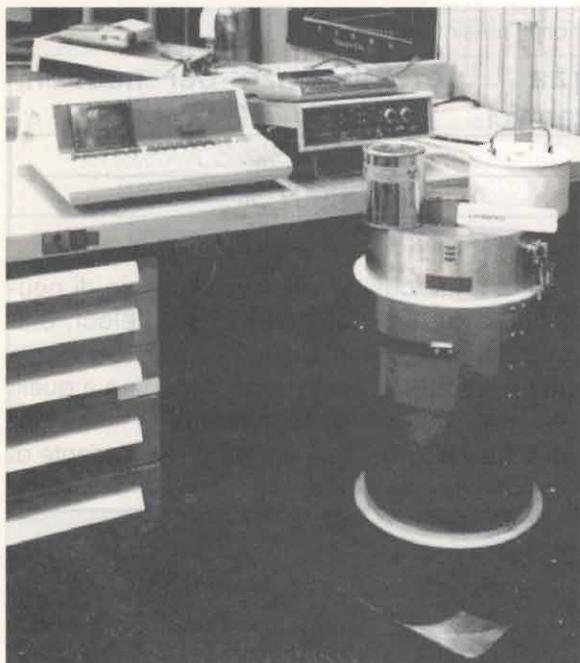
figura 11 - Un rivelatore al trifluoruro di boro con relativi accessori: alimentatore/preamplificatore (sul banco, a dx) e multicanale (a sx). Il tubo contatore, immerso nel bidone di moderatore (acqua) in basso a dx che contiene anche una sorgente di neutroni da laboratorio, non è visibile.
