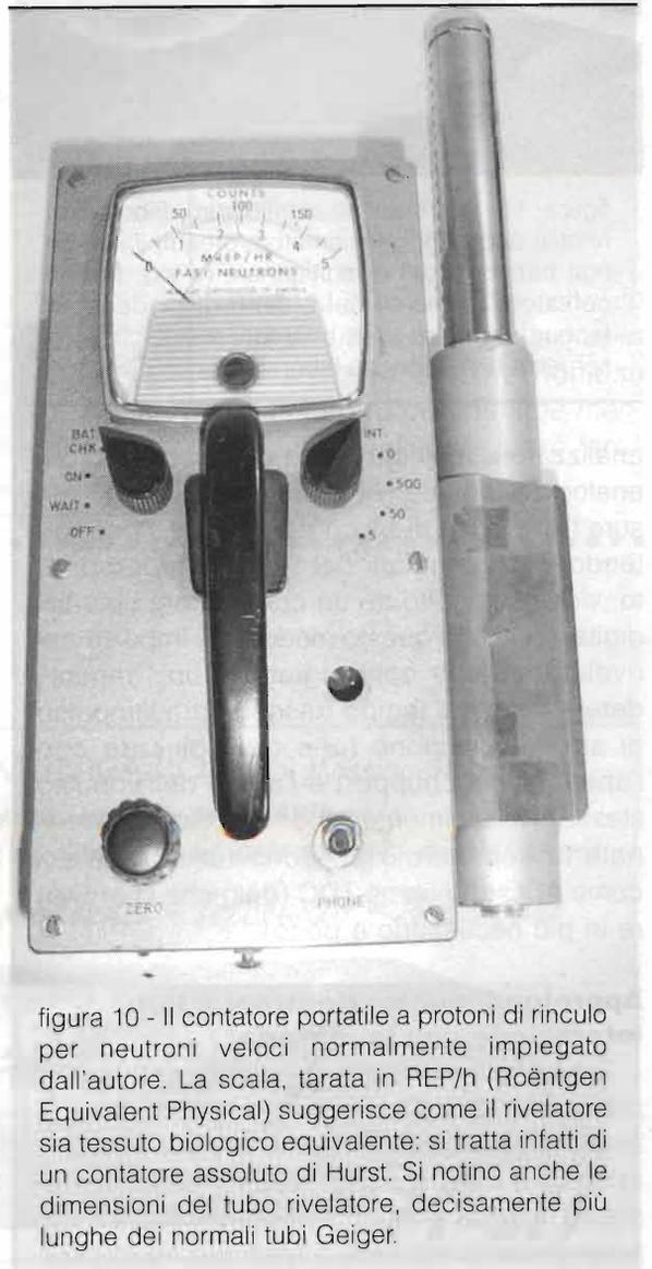
figura 10 - Il contatore portatile a protoni di rinculo per neutroni veloci normalmente impiegato dall'autore. La scala, tarata in REP/h (Roentgen Equivalent Physical) suggerisce come il rivelatore sia tessuto biologico equivalente: si tratta infatti di un contatore assoluto di Hurst. Si notino anche le dimensioni del tubo rivelatore, decisamente più lunghe dei normali tubi Geiger.
